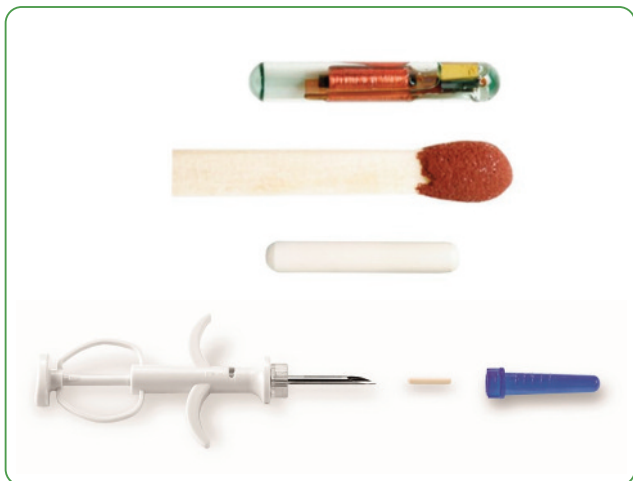
Afbeelding 2: De glazen transponders zijn al een stuk kleiner geworden dan de eerste versies en de huidige biopolymeer transponders zijn nog iets kleiner (10,9 mm lang en een diameter van 1,9 mm); hierdoor konden de naalden voor inbrengen ook iets dunner worden (met dank aan Virbac Animal Health).
