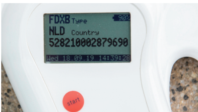
Afbeelding 4: Een ISO-reader leest uitsluitend het type transponder, het land en het transpondernummer uit.
